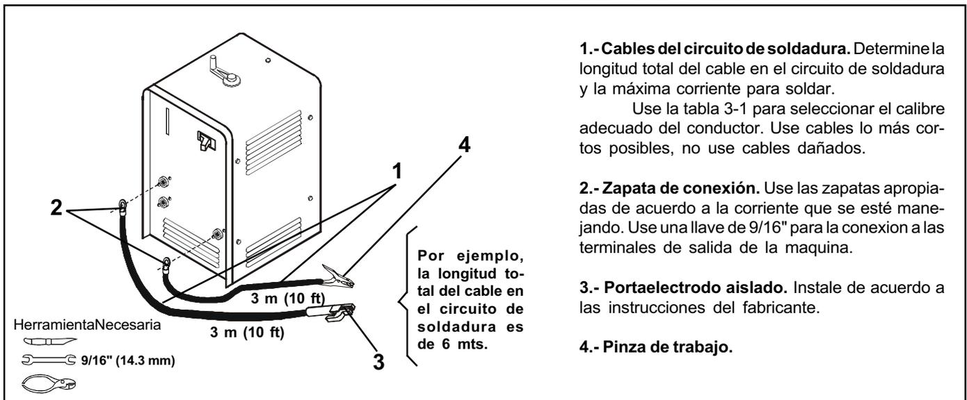
FIGURA 3-3 SELECCION DE LOS CABLES PARA SOLDAR
