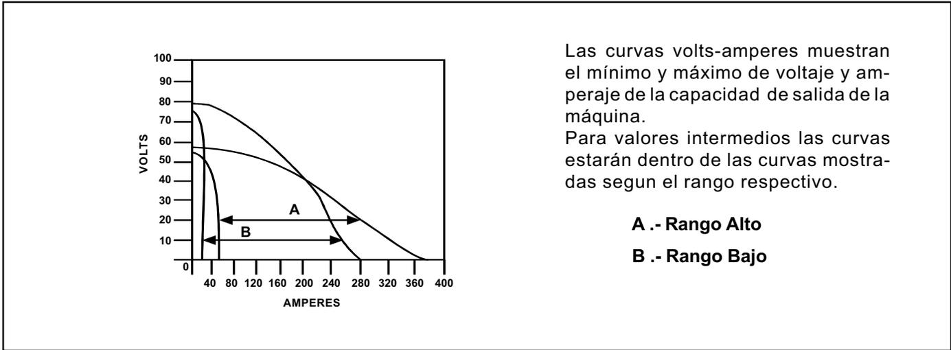
Las curvas volts-amperes muestran el mínimo y máximo de voltaje y amperaje de la capacidad de salida de la máquina.
