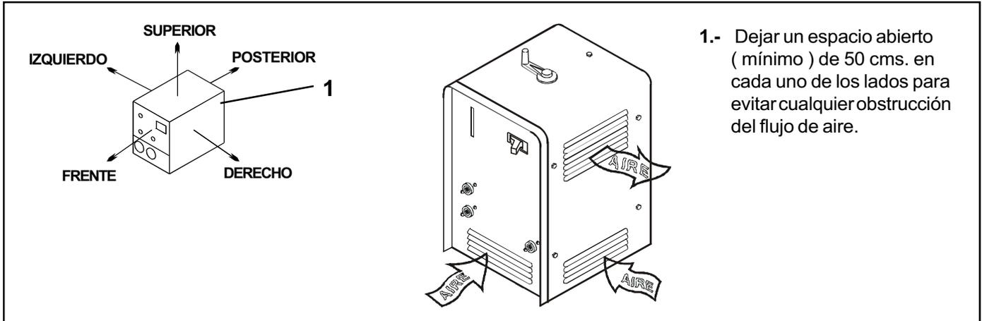
FIGURA 3-1 LOCALIZACION Y MOVIMIENTO DE LA MAQUINA SOLDADORA
