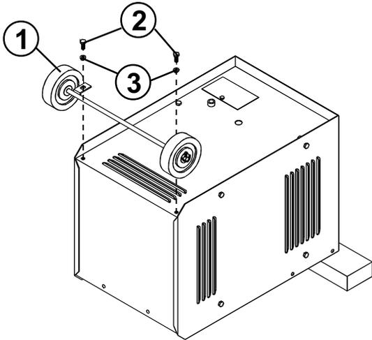
**1.** - Coloque la rodaja armada (1) en los barrenos que se localizan en la parte posterior inferior de la máquina, fijándola con el tornillo de 1/4" (2) y su respectiva rondana de presión 1/4" (3) como se muestra en la figura.
