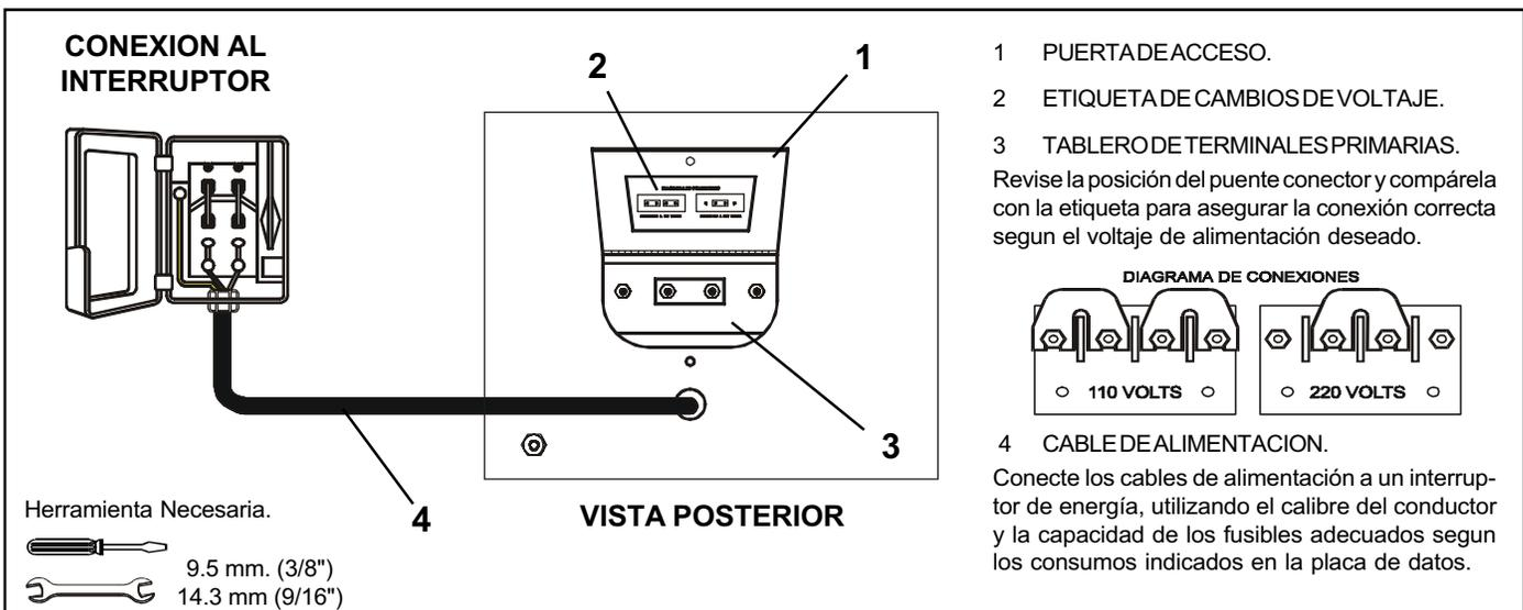
FIGURA 3-4 CONEXIONADO EN LAS TERMINALES DE ENTRADA
