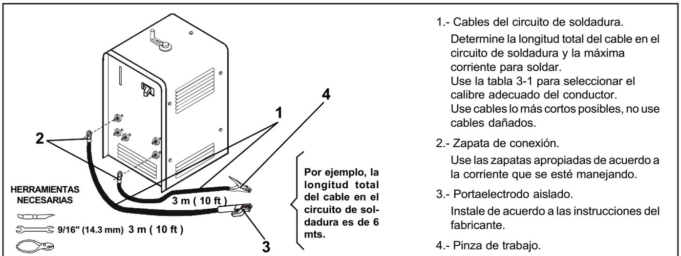
FIGURA 3-3 SELECCION DE LOS CABLES PARA SOLDAR
